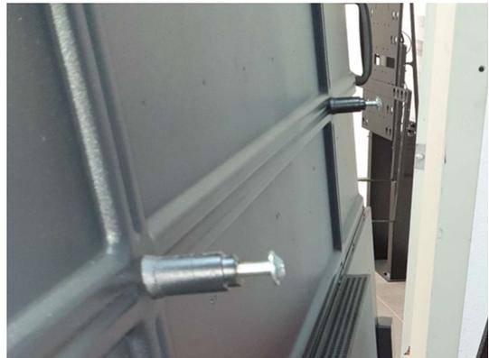
Die Schrauben werden anschließend in die Vesaaufnahmen des Rahmens eingehangen ...und anschließend angezogen.
