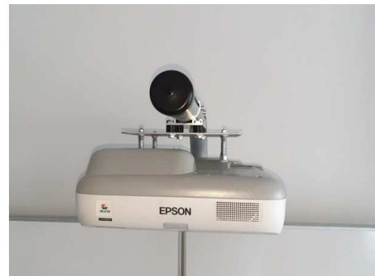
Befestigung der Beameraufnahme an dem Galgen
