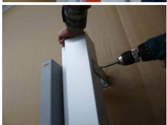
Das Montageplättchen zur Befestigung der vorderen Pylone wird zunächst an der hinteren angebracht. Dies geschieht nur auf der Innenseite mittels zwei mitgelieferten Bohrschrauben.
