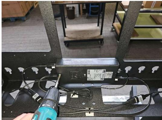
Befestigen Sie Taster und Zugentlastung an der Unterseite des Oberteils.
